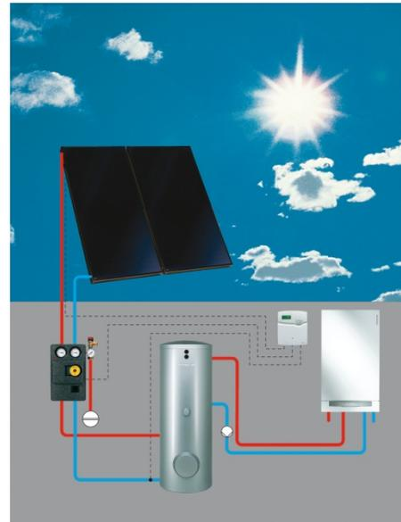
Abbildung 3.2.1-1 Brennwert-Solar-Kombination
